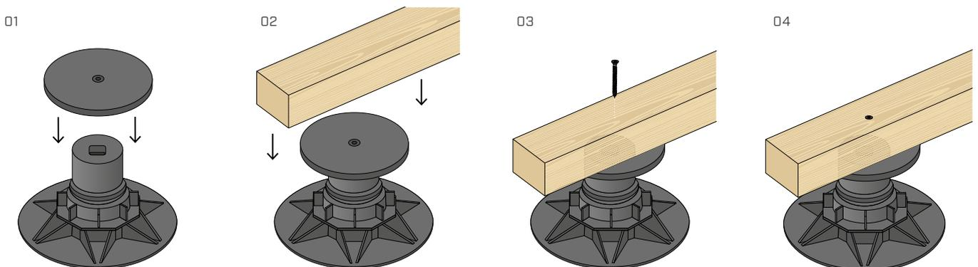
Den Kopf SUPMHEAD1 auf den Träger SUP-M positionieren und die Leiste mit KKF-Schrauben, Durchmesser 4,5 mm, befestigen.
