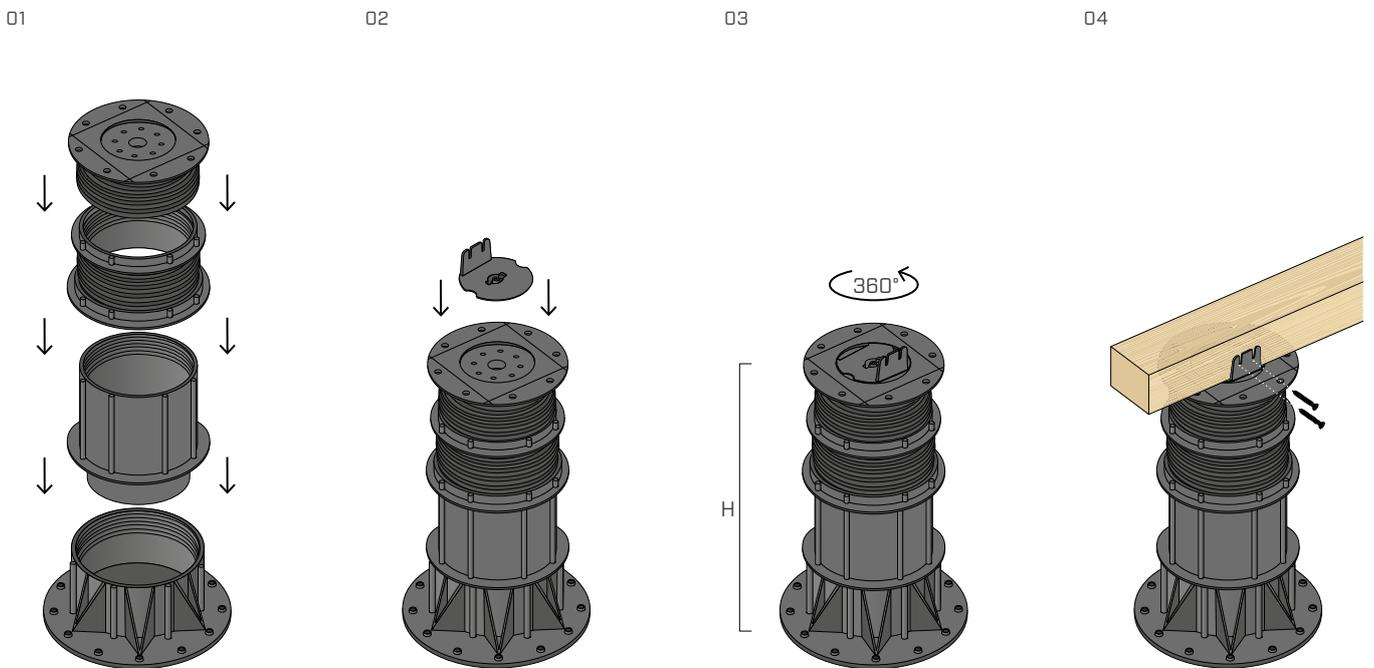
Die Verlängerung SUPLEXT100 dem Träger SUP-L hinzufügen und danach den Kopf SUPSLHEAD1 positionieren. Die Höhe wie gewünscht einstellen und die Leiste seitlich mit KKF-Schrauben, Durchmesser 4,5 mm, befestigen.
