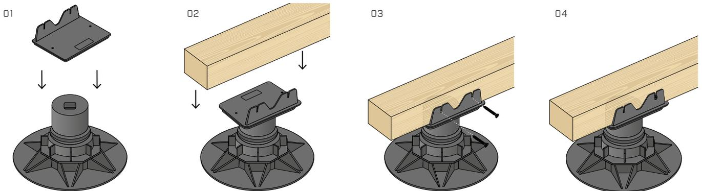
Den Kopf SUPMHEAD2 auf den Träger SUP-M positionieren und die Leiste seitlich mit KKF-Schrauben, Durchmesser 4,5 mm, befestigen.
