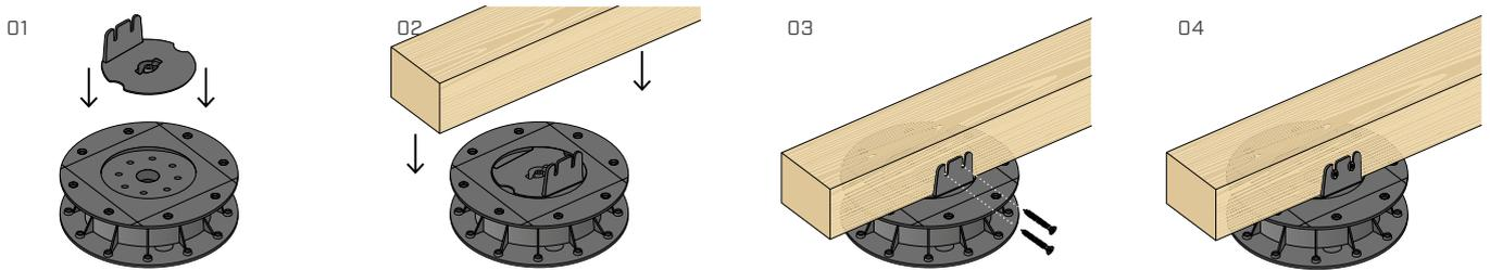
Den Kopf SUPSLHEAD1 auf den Träger SUP-S positionieren und die Leiste mit KKF-Schrauben, Durchmesser 4,5 mm, befestigen.
