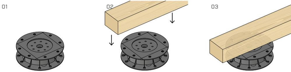
Die Unterkonstruktion kann einfach auf den Träger SUP-S aufgelegt oder mit KKF-Schrauben, Durchmesser 4,5 mm, eingeschraubt werden.
