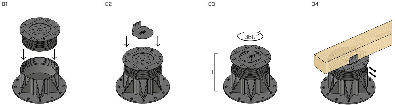
Den Kopf SUPSLHEAD1 auf den Träger SUP-L positionieren, die Höhe wie gewünscht einstellen und die Leiste seitlich mit KKF-Schrauben, Durchmesser 4,5 mm befestigen.
