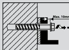
5. Sollte die erste Unterfütterung nicht ausreichen, ist eine wiederholte Adjustierung möglich. Hierzu darf die Betonschraube wiederum um maximal 10 mm zurück gedreht werden damit eine weitere Unterfütterung angebracht werden kann.
