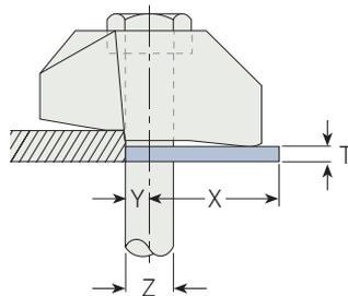
Unterlegscheiben zum Ausgleich verschiedener Flanschdicken. Der Typ AFCW hat vor der Montage eine leicht gebogene Form, die nach der Installation flach ist.
