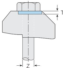
Einlegeteil für die Vertiefung des Typs AF als Auflage für Mutter oder Schraubenkopf. Bei Ermittlung der Schraubenlänge das Maß T addieren.
