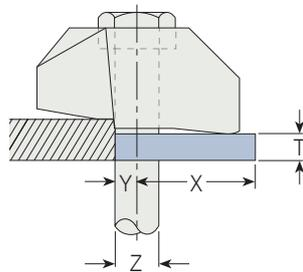
Unterlegscheiben zum Ausgleich verschiedener Flanschdicken.
